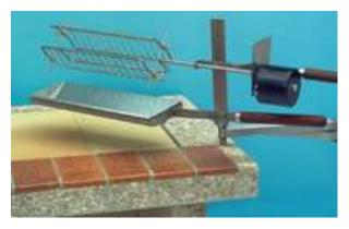
Das Gestänge des Bratkorbes wird in den Motorenhalter eingeführt. Der Motor wird im Motorenhalter eingesetzt (den Zapfen des Motors fixieren Sie in der speziellen Lochung im Halter). Anschliessen drehen Sie das Gestänge des Bratkorbes ins Gewinde des Motors. (sollte der Bratkorb/Spiess anschliessend nicht schön rund drehen, ist er nicht genügend im Motor festgeschraubt)
